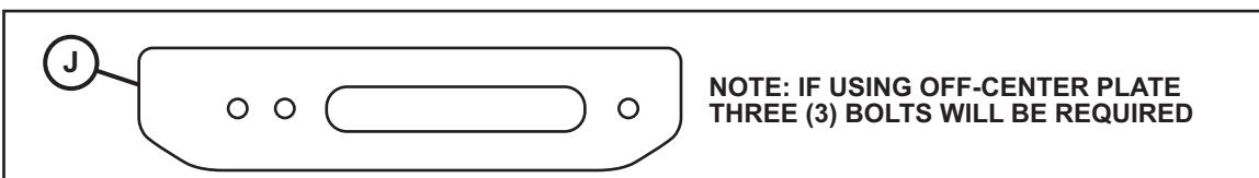
Remarque: Si la plaque décentrée est en cours d'installation, trois boulons seront nécessaires
