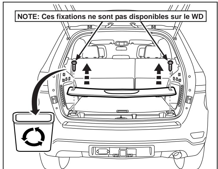
31. Déposez et sortez du véhicule le panneau de plancher du coffre.
