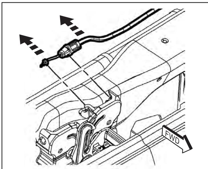
5. Vuelva a conectar el cable de liberación del pestillo del capó a la parte trasera del conjunto de pestillo nuevo del capó. Ponga el pestillo nuevo (A) sobre las marcas de alineación y sujetelo con dos (2) pernos hexagonales. Apriete los pernos a 11 Nm (8 pies-lb).
