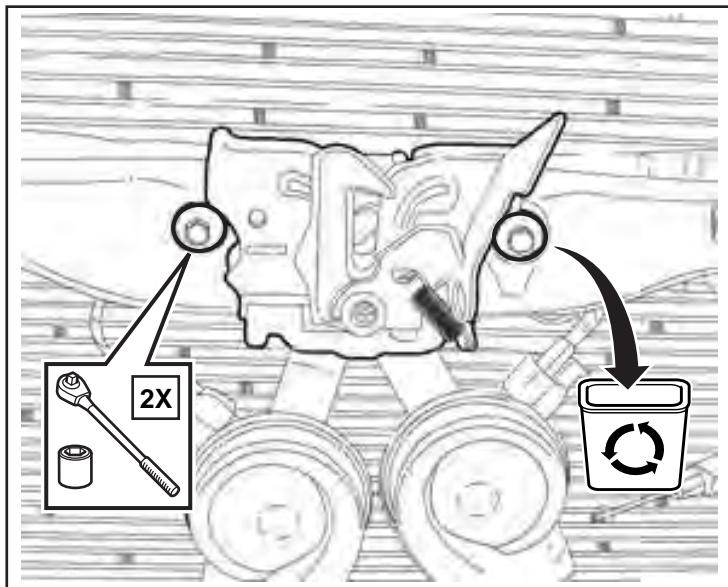
4. Desprenda con cuidado el panel de cubierta del radiador. Desconecte y retire el cable de liberación del pestillo del capó. Quite el conjunto del pestillo del capó.
