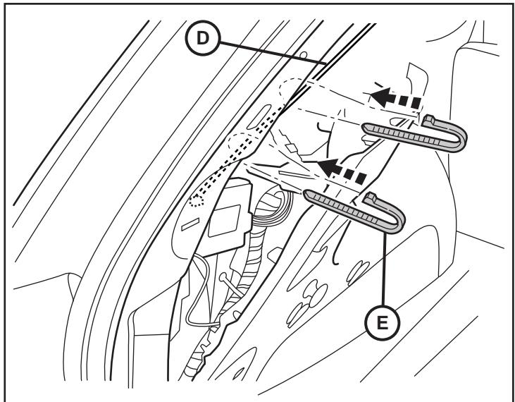
**42. Revise todo los cables y recorte todos los sujetacables.**
