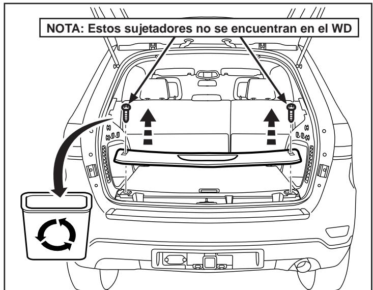
31. Retire el panel de la cubierta de carga del vehículo.
