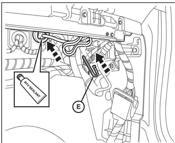
**ATTENTION : La reconfiguration de véhicule (à l'aide de l'outil à balayage diagnostique) doit être effectuée avant d'installer le nouveau module RFHM. Ne pas se conformer à cette directive rendra la fonction de démarrage à distance du module RFHM non fonctionnelle. Le technicien devra attendre 30 minutes après avoir ajouté le code de ventes XBM au système DealerConnect avant de restaurer la configuration du véhicule.**
