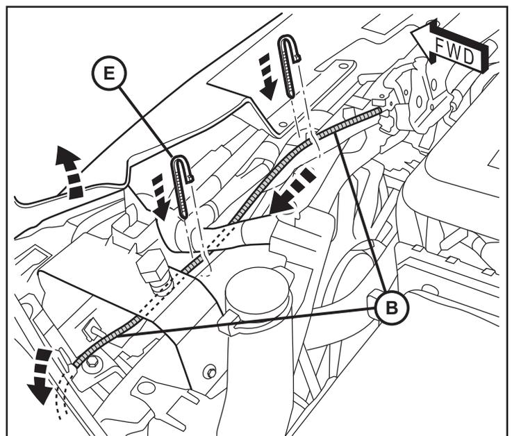
7. Encause el mazo del interruptor (B) junto con los mazos existentes en el vehículo sobre el lado del conductor y de regreso hacia la parte trasera del compartimiento del motor. Coloque el arnés detrás de la caja de fusibles, como se muestra.
