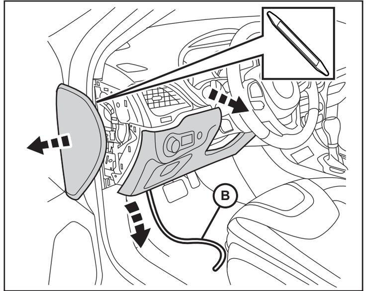
11. Quite los dos (2) tornillos de la palanca de apertura del cofre montaje y bajar el conjunto hacia abajo bajo la salpicadero.
