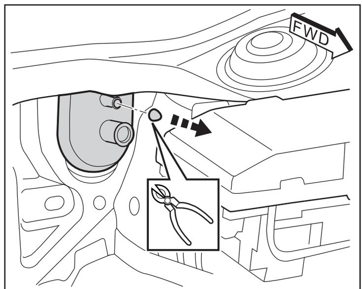
10. À l'aide de l'outil pour garnitures, déposez le capuchon d'embout du tableau du côté conducteur. Retirez le panneau de garniture inférieure sous la colonne de direction. Tirez le commutateur Harnais (B) à travers le plancher à l'intérieur.
