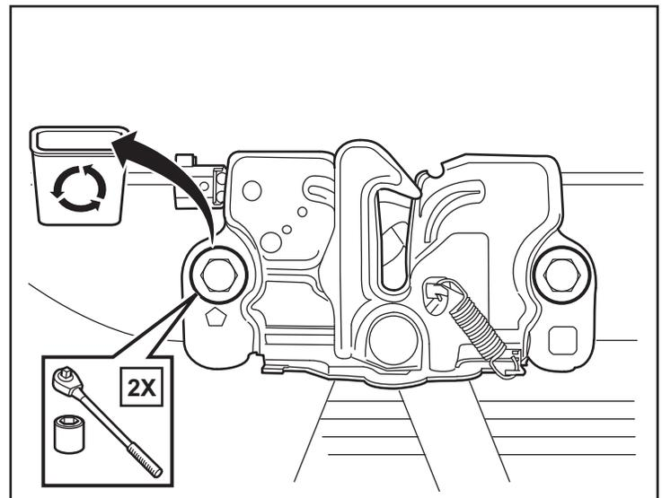
3. Soulevez délicatement le panneau recouvrant le radiateur. Débrancher et déposer le câble de déverrouillage du capot. Déposez l'ensemble de verrouillage du capot.
