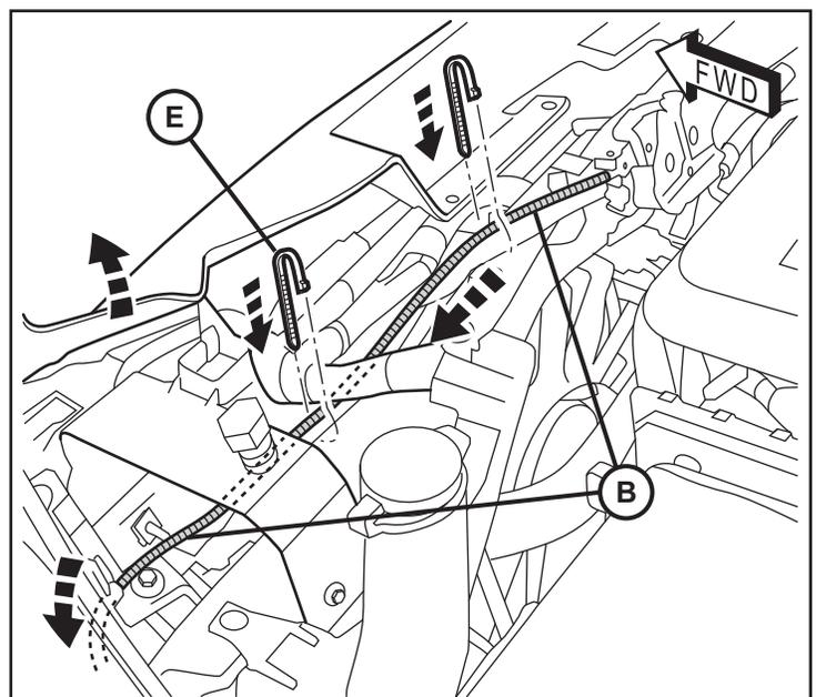
7. Faites passer le faisceau de câbles du commutateur (B), le long des faisceaux existants du véhicule vers le côté conducteur et puis vers l'arrière du compartiment moteur. Route fil derrière la boîte à fusibles.
