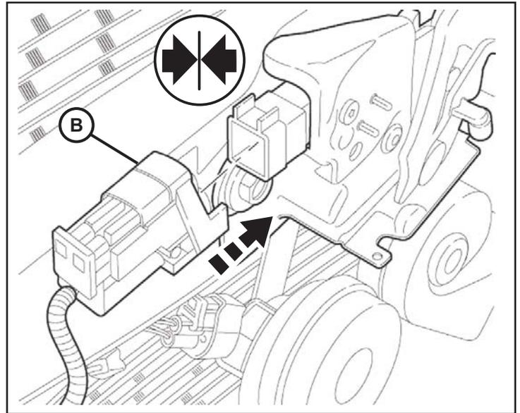
6. Desprenda con cuidado el panel de cubierta del radiador. Encause el mazo del interruptor (B) hacia el lado del conductor junto con el arnés del vehículo existente. Alimente el cableado del interruptor bajo las mangueras y soportes como se muestra. Sujételo con un sujetacables (E).
