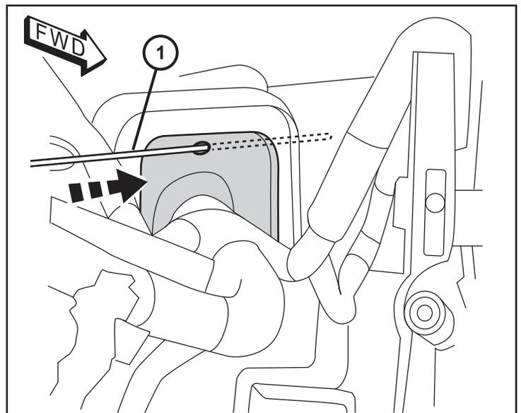
13. Fixer l'extrémité du fil (B) à la tige métallique avec un morceau de ruban adhésif. Tirer le faisceau de câbles par l'intermédiaire de l'intérieur du véhicule, sous le tableau de bord. Appliquer du RTV mastic pour le câblage électrique et tirez sur le faisceau de câbles dans le tube à sceller.
