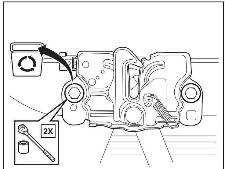
3. Desprenda con cuidado el panel de cubierta del radiador. Desconecte y retire el cable de liberación del pestillo del capó. Quite el conjunto del pestillo del capó.
