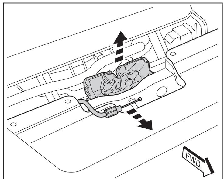
4. Rebranchez le câble de déverrouillage du capot à l'arrière du nouvel ensemble de verrouillage. Alignez le nouveau verrou de capot (A) sur les marques d'alignement et fixez-le avec deux (2) boulons hexagonaux. Serrez les boulons au couple de 11 N-m (8 lb-pi).
