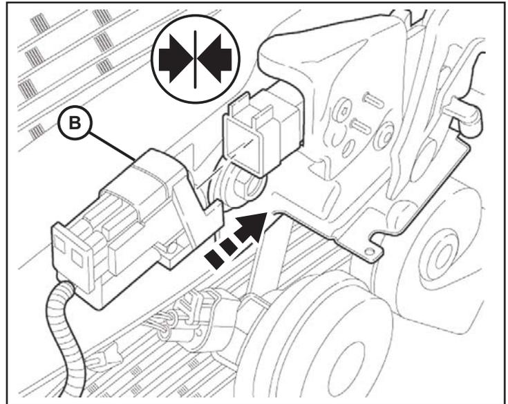
6. Soulevez délicatement le panneau recouvrant le radiateur. Acheminez le faisceau de câbles du commutateur (B) le long du faisceau de câbles principal du véhicule, en direction du côté du conducteur. Nourrir le harnais dans les tuyaux comme indiqué. Fixez les deux faisceaux ensemble avec des serre-câbles (E).
