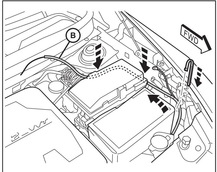
8. Le long du bord extérieur à côté de la batterie, retirez l'existant écrou fil de terre. Placer la cosse de masse (B) du faisceau de câbles principal en position et refixer l'écrou.
