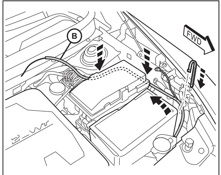
8. En el borde exterior próximo a la batería, retire la tuerca para cable existente. Coloque el suelo anillo terminal del arnés principal (B) y vuelva a colocar la tuerca para fijarlo.
