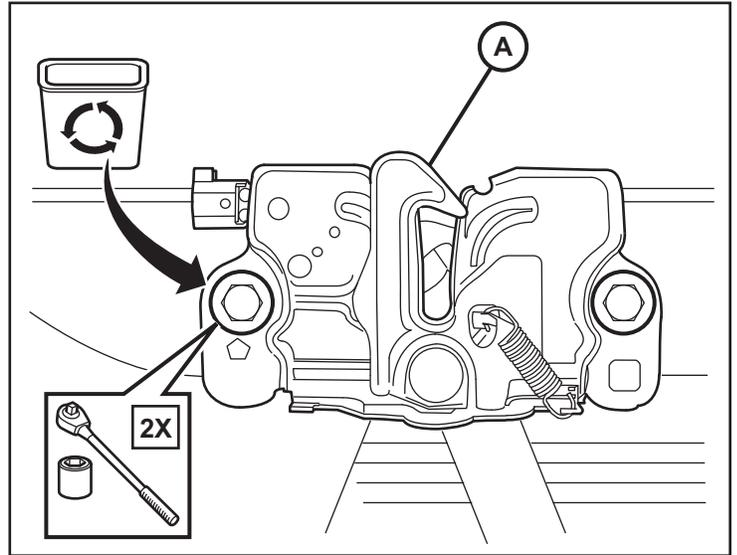
**NOTA:** Podría haberse instalado un mazo para el interruptor en la fábrica. De ser así, desprenda el conector, páselo por debajo del travesaño y conéctelo al conjunto de pestillo del capó, luego continúe con el Paso 20.
