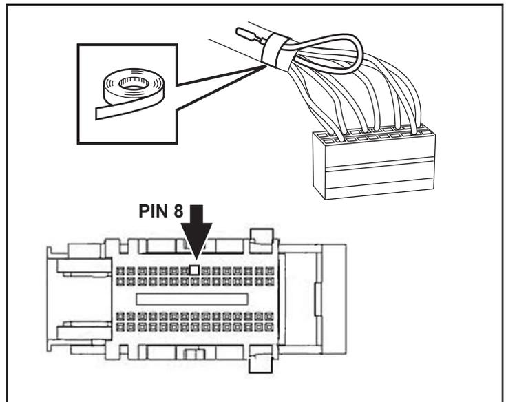
17. Inserte el conector de cable con lengüetas del mazo del interruptor (B) en la clavija 8 del conector.
