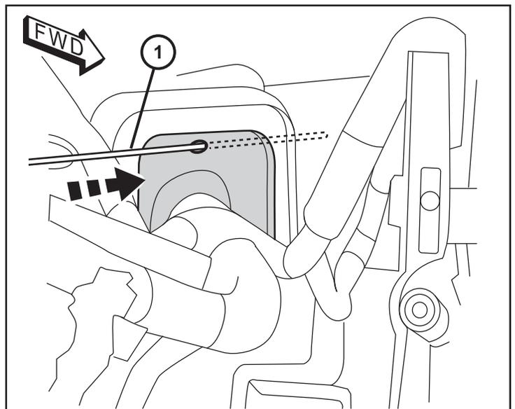
13. Asegure el extremo del mazo de cables al alambre de metal de largo con un trozo de cinta. Tire del extremo del arnés (B) a través de la parte interior debajo del tablero. Aplicar RTV sellador en el cableado y tire de los cables en el tubo para sellar el cableado en el tubo.
