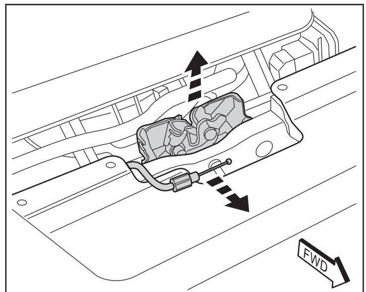
4. Vuelva a conectar el cable de liberación del pestillo del capó a la parte trasera del conjunto de pestillo nuevo del capó. Ponga el pestillo nuevo (A) sobre las marcas de alineación y sujételo con dos (2) pernos hexagonales. Apriete los pernos a 11 Nm (8 pies-lb).
