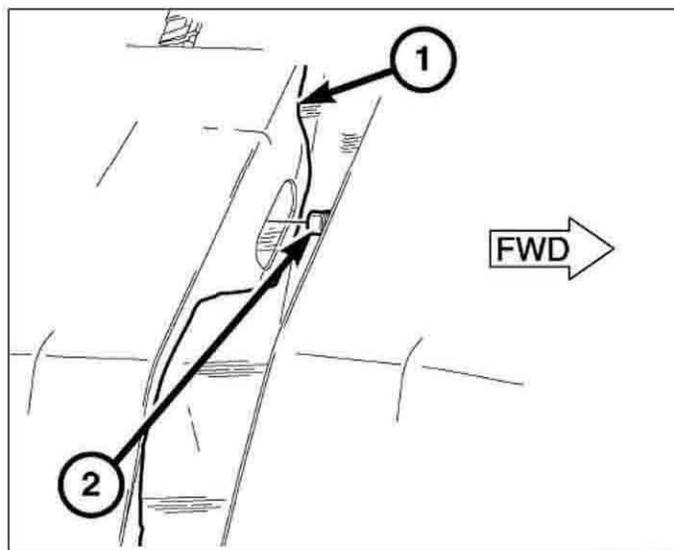
25. Aligner les pattes de l'aile du bouclier dans les fentes de retenue de l'aile et pousser le bouclier (1) vers l'avant pour l'engager.
