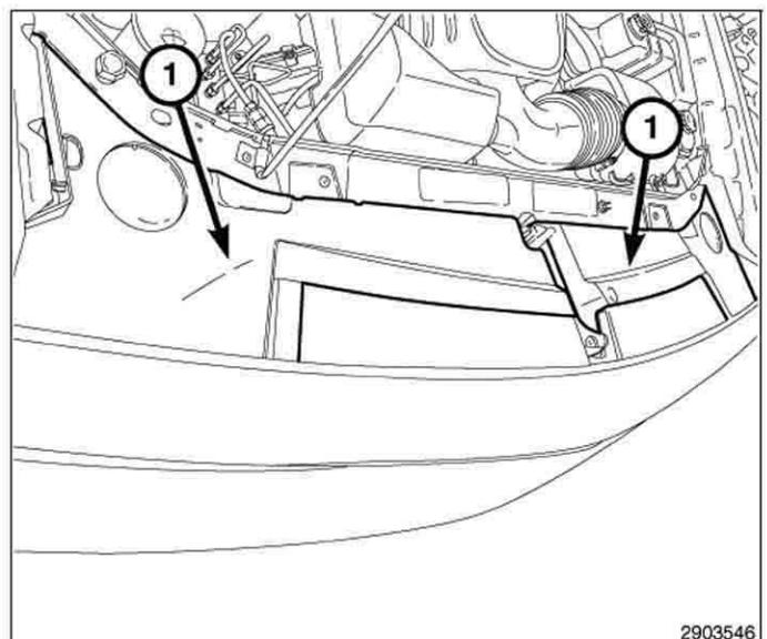
13. Retire la tuerca (1) que fija la parte superior delantera de la aleta a la parte superior del frente. Guárdelos para su reutilización.
