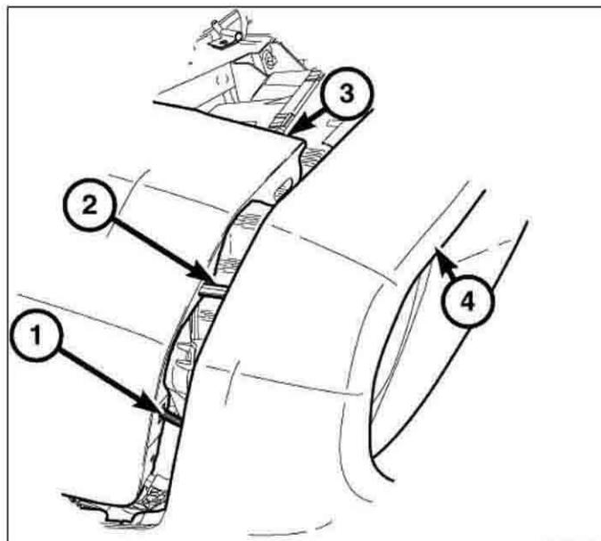
24. Presser fermement sur l'avant du bouclier, s'assurer que le goujon de retenue supérieur du bouclier (2) est aligné la patte de l'aile respective (1) jusqu'à bien assujetti. Répéter ces étapes pour le côté opposé.
