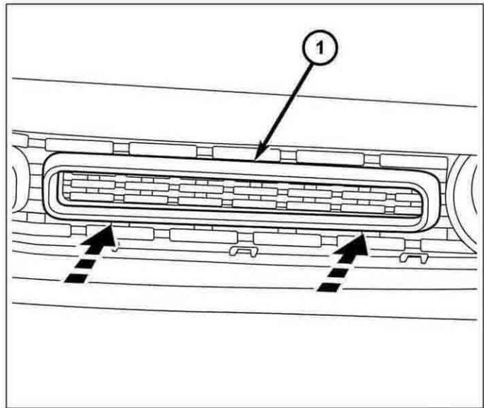
20. Insérez soigneusement les huit clips de fixation (1) en position d'obtenir l'anneau de garniture du côté du conducteur.
