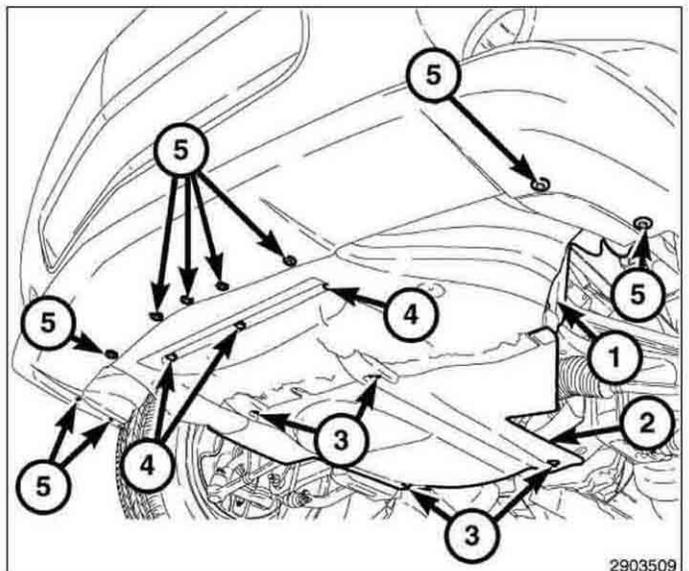
34. Utiliser un rivet neuf et un pistolet à riveter pour poser le rivet (1) qui fixe l'écran pare-boue à l'aile.
