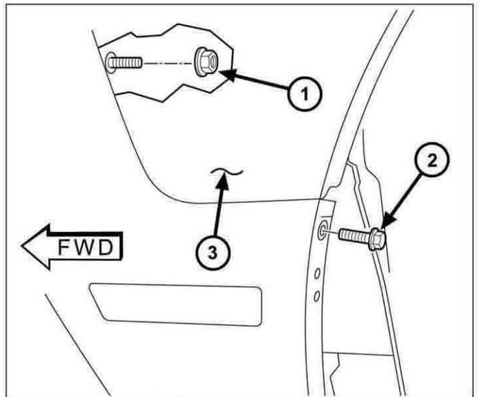
32. Monte las cubiertas del cárter delantera y trasera (1, 2).
