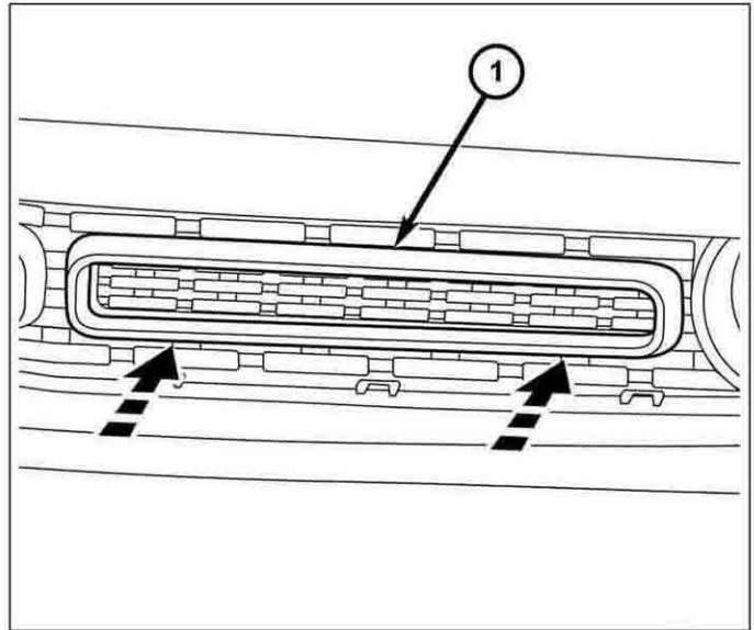
20. Introduzca con cuidado los ocho clips de montaje (1) en su posición para asegurar el anillo de ajuste del lado del conductor.
