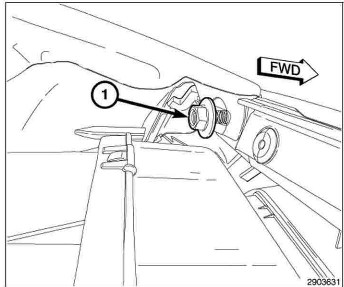
14. Déposer les fixations (1) du bouclier supérieur à la traverse supérieure du radiateur du côté droit du véhicule. Réserver pour réutilisation.
