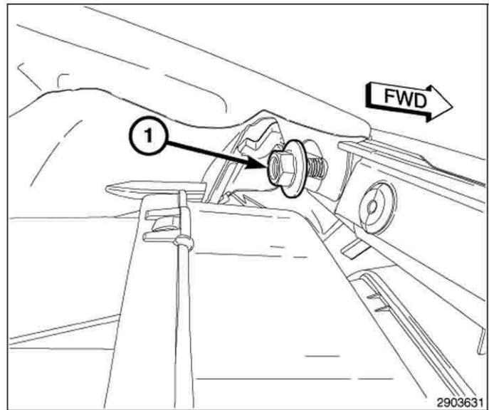
14. Retire los tres elementos de fijación del frente al travesaño superior del radiador (1) en los lados derecho e izquierdo del vehículo. Guárdelos para su reutilización.
