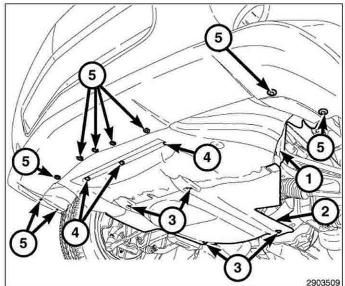
9. Retire la tuerca (1) y un perno (2) que fija la parte inferior del panel al interior de la aleta (3). Puede acceder a esta tuerca (1) a través de la abertura que está entre el guardabarros del paso de rueda y el frente. Guárdelos para su reutilización.
