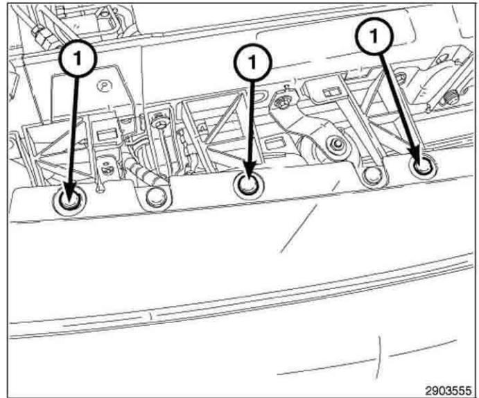
27. Poser l'écrou (1) qui fixe l'avant supérieur de l'aile au bouclier supérieur. Serrer l'écrou à de (1) à 3 N-m (26.5 lb po).
