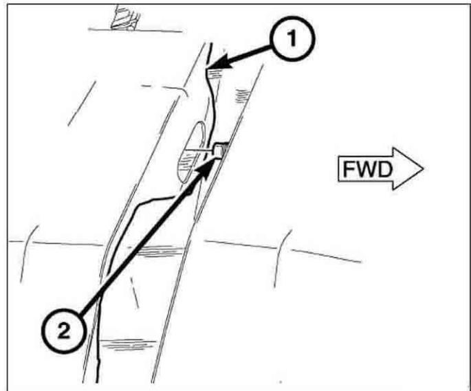
25. Alinee las lengüetas del frente en las ranuras de fijación de la aleta y presione el frente (1) hacia adentro para encajarlo.
