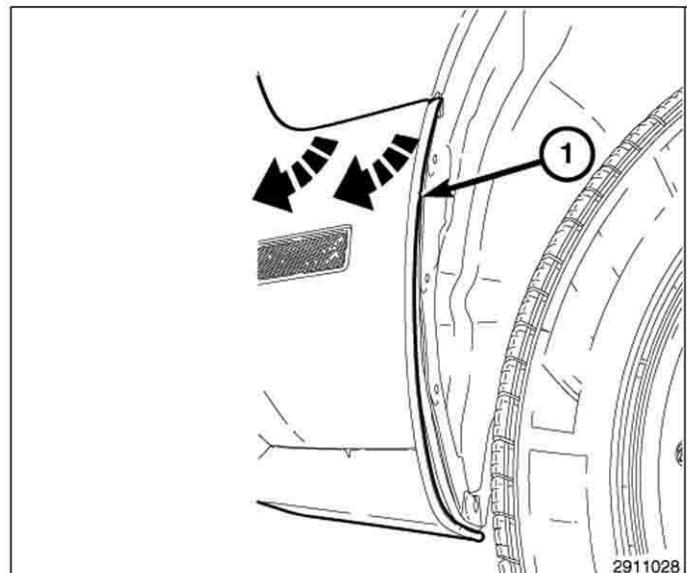
16. Avec l'aide d'un assistant, tirer le bouclier (1) de l'avant et déposer le bouclier (1) du véhicule.
