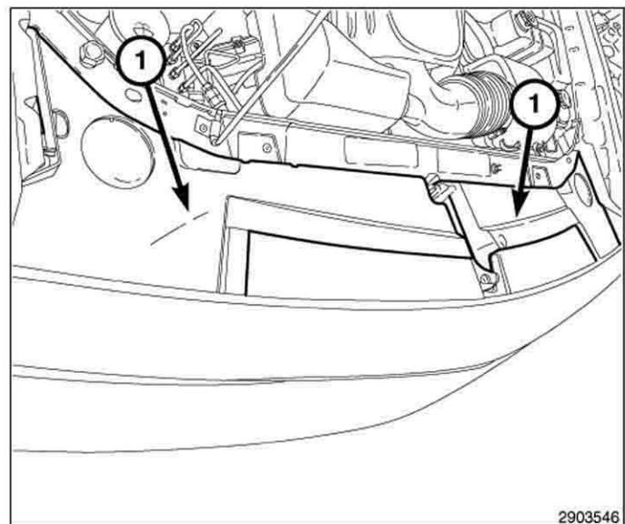
13. Déposer l'écrou (1) qui fixe la partie supérieure de l'aile au bouclier supérieur. Réserver pour réutilisation.
