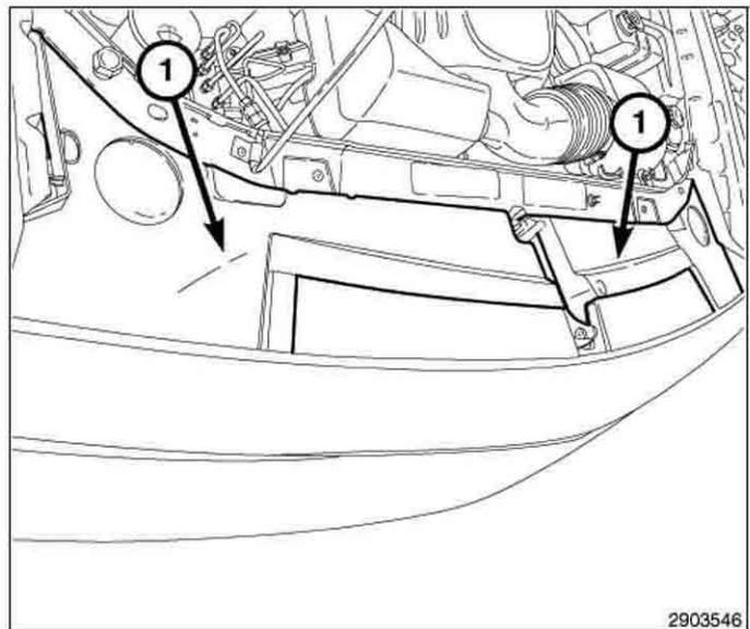
30. Según versiones, enchufe el mazo de cables principal de las luces antiniebla (1, 2). El mazo de cables se encuentra cerca de la parte inferior del depósito de líquido lavaparabrisas.
