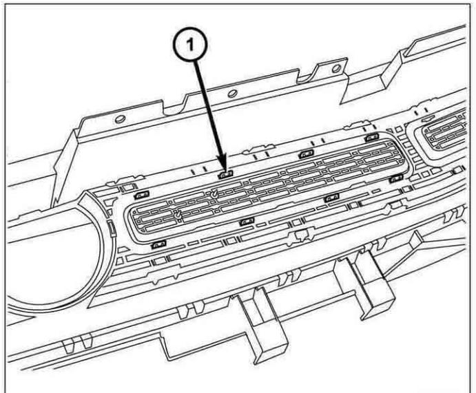
19. Inserte la pieza de adorno nuevo del lado del conductor (1) en la posición indicada.
