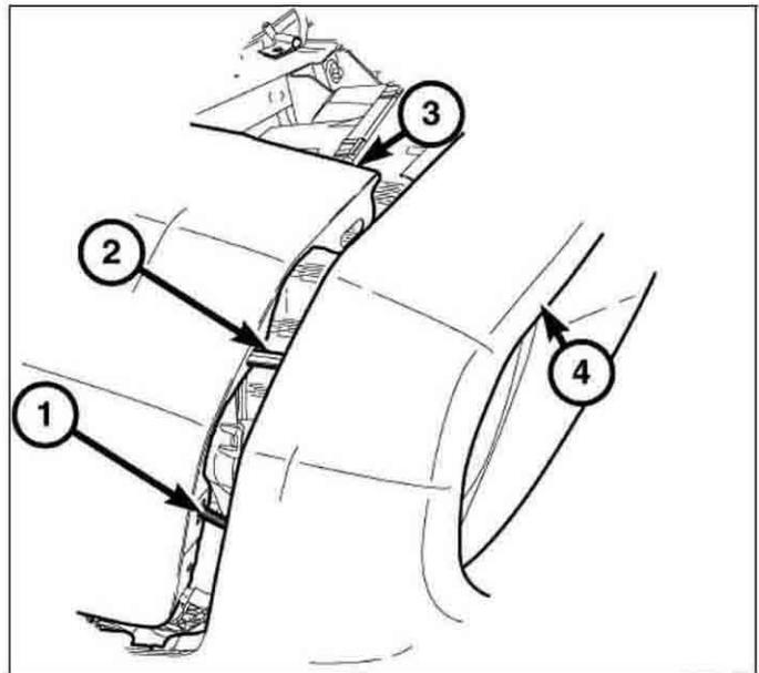
24. Presione con firmeza sobre la parte delantera del frente. Asegúrese de que el vástago de fijación superior del frente (2) esté alineado con su respectiva lengüeta de la aleta (1) hasta que quede totalmente asentado. Repita los pasos en el lado opuesto.
