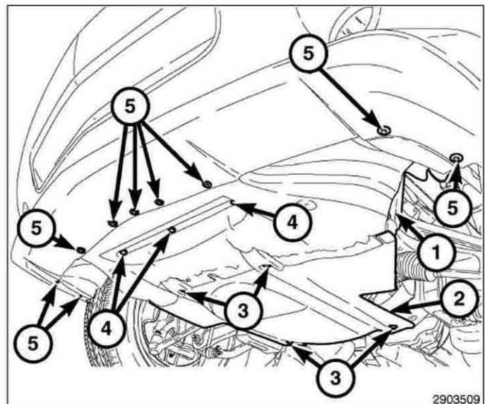
9. Déposer l'écrou (1) et un boulon (2) qui fixe la partie inférieure du bouclier au blindage inférieur (3). Accéder à l'écrou (1) à travers l'ouverture entre l'éncran pare-boue du passage de roue au bouclier. Réserver pour réutilisation.
