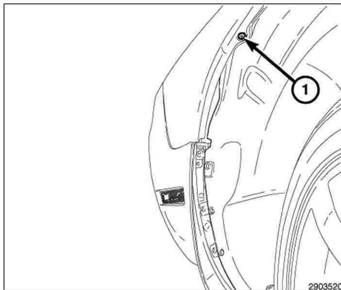
35. Utiliser des rivets neufs et un pistolet à riveter pour poser les trois rivets (1) qui fixent l'écran pare-boue au bouclier et mettre les rivets usagés au rebut.
