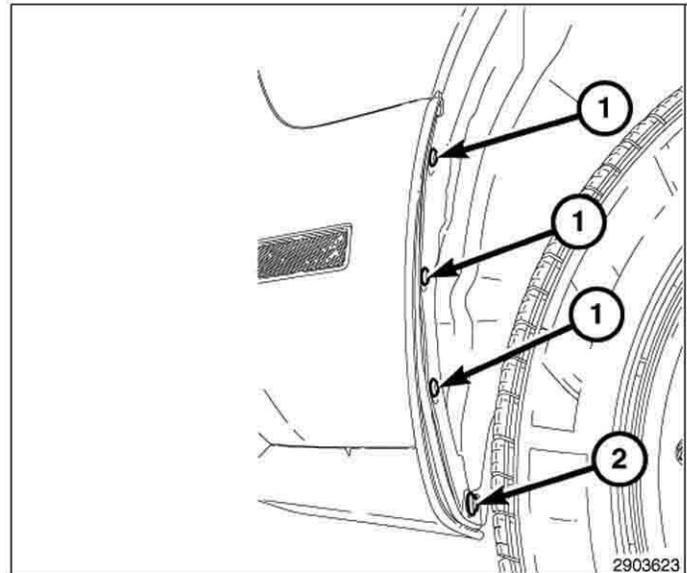
6. Déposer le rivet (1) qui fixe l'écran garde-boue à l'aide et le mettre au rebut.
