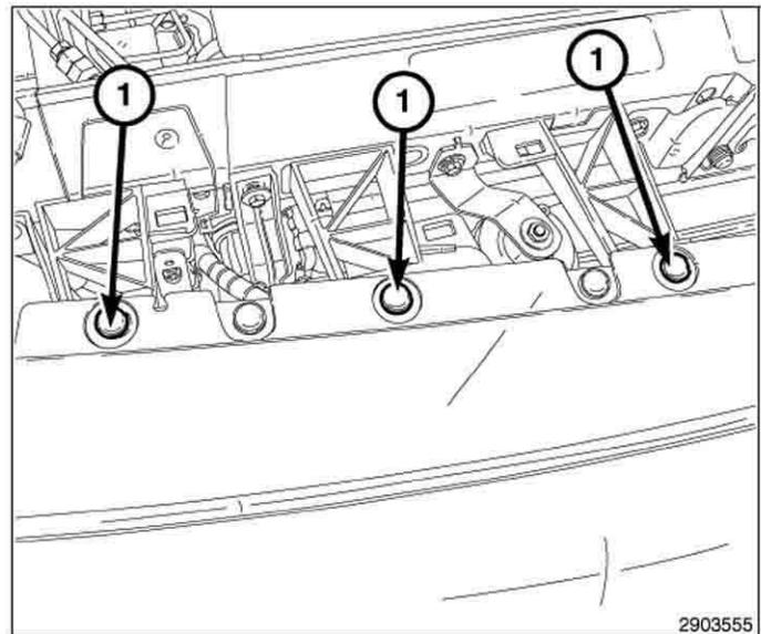
15. Tirer avec soin le bouclier vers l'extérieur (1) du passage de roue pour désengager les pattes de l'aile des fentes de retenue de l'aile.
