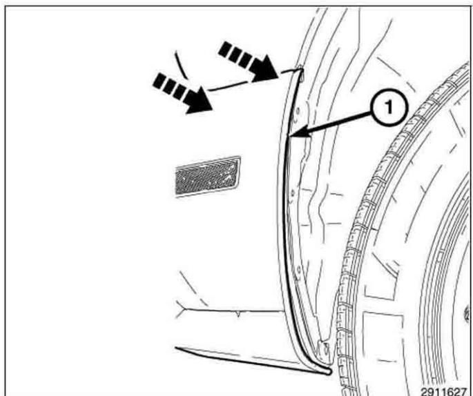
26. Monte los tres elementos de fijación del frente al travesaño superior del radiador (1) en los lados derecho e izquierdo del vehículo.
