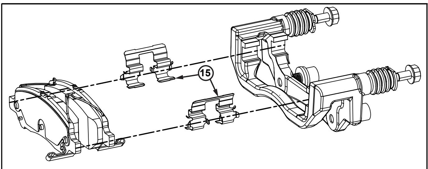
16. Instale las pastillas (16) en el soporte del adaptador de la pastilla, asegurándose de que los indicadores de desgaste se encuentran en la parte inferior opuesta al tornillo de sangrado.
