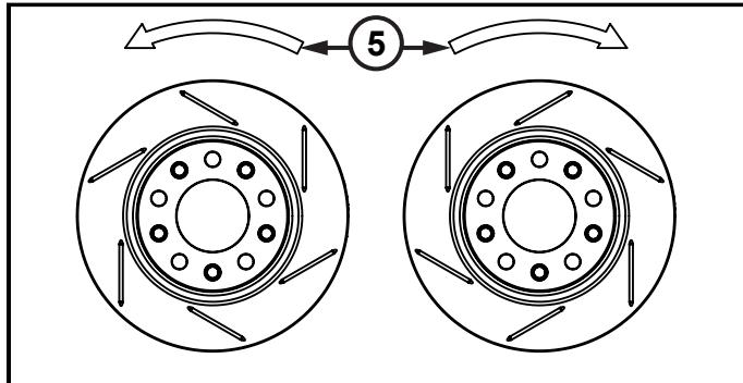
11. Installer le nouveau disque de frein (6) sur le moyeu à roulement.
