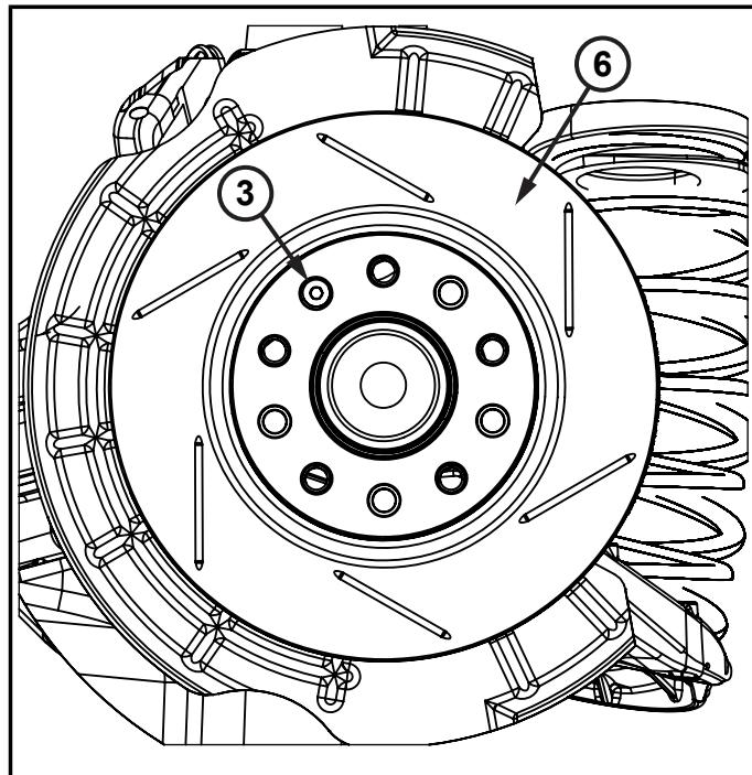
13. Installer le support d'étrier et poser (2) boulons d'étrier **NEUFS** à la place des anciens boulons jetés. Serrer les boulons à un couple de 65 N·m (48 pi-lb).
