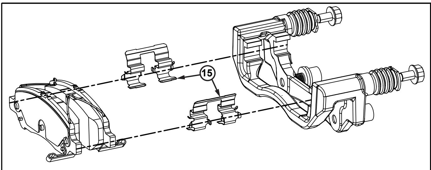
16. Installer les plaquettes (16) dans l'adaptateur d'étrier en vérifiant que les témoins d'usure sont en bas, du côté opposé à la vis de purge.
