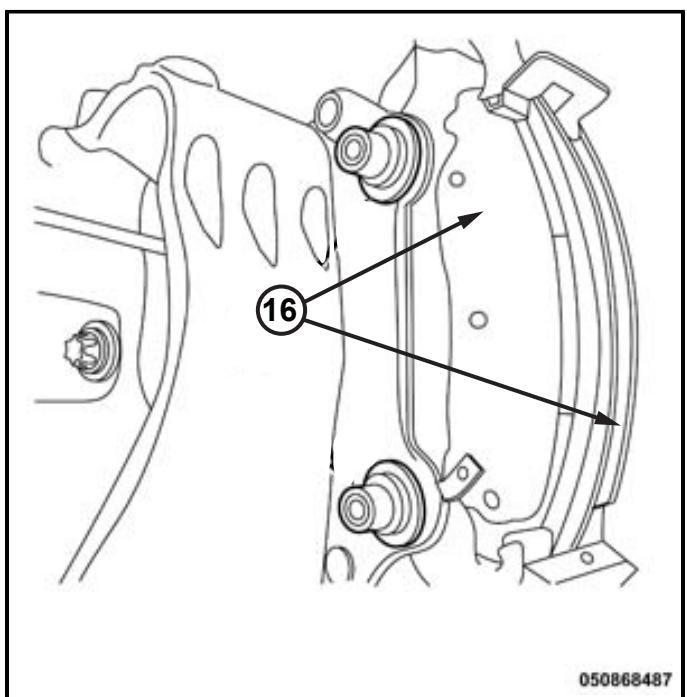
**MISE EN GARDE :** Lors de la pose de l'étrier dans l'adaptateur, prendre garde de ne pas abîmer les soufflets des tenons de guidage.
