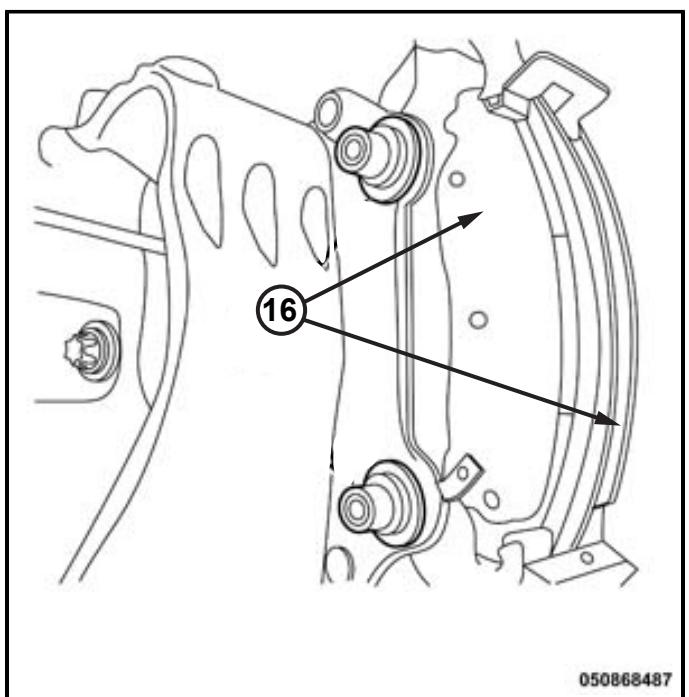
**ADVERTENCIA:** Tenga cuidado al colocar la pinza en el adaptador del freno de disco para evitar dañar los tornillos de los pernos de guía.
