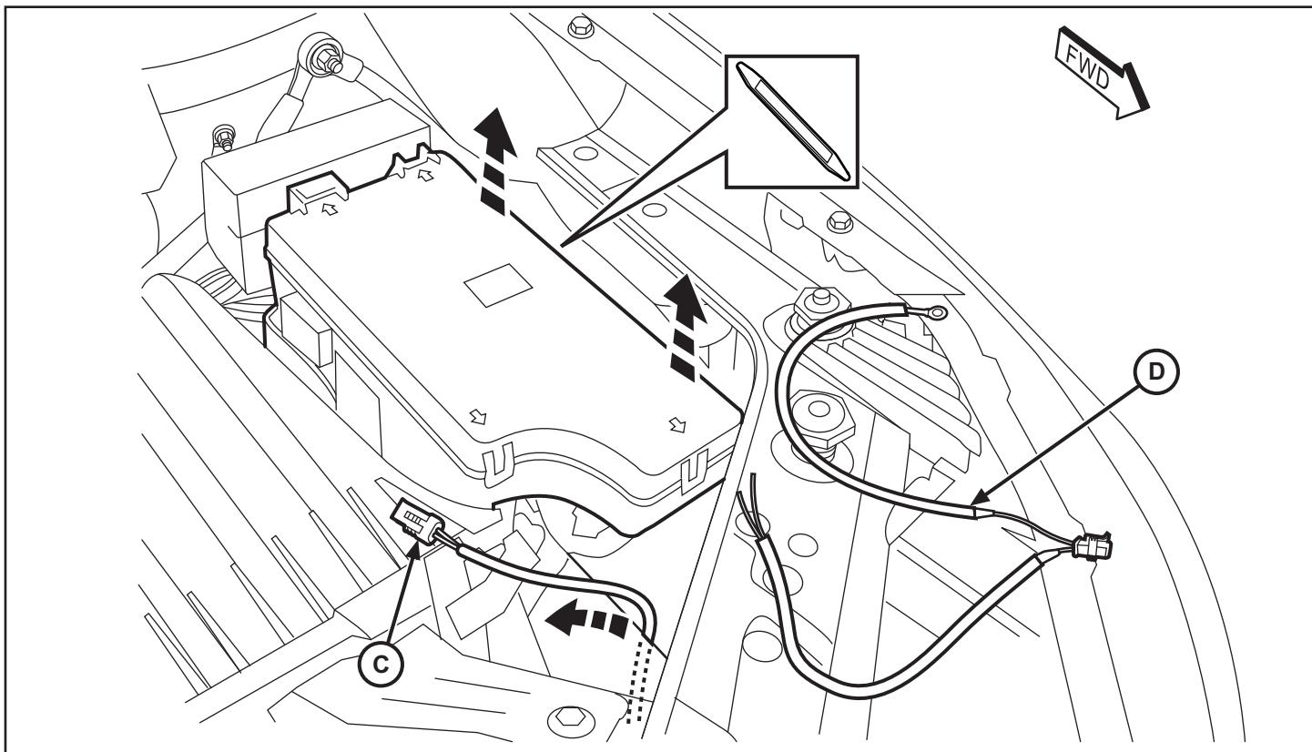
14. Localice y desconecte los dos enchufes que se muestran (C7 y C5). Extraiga con cuidado los enchufes de la caja de fusibles para Poder tener acceso a los arneses de cables.
