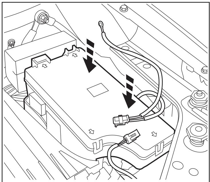
18. Localice el cable de tierra detrás de la caja de fusibles. Quite una (1) tuerca de 10mm e instale el ojal de tierra del arnés de corriente (D). Vuelva a conectar el cable de tierra.
