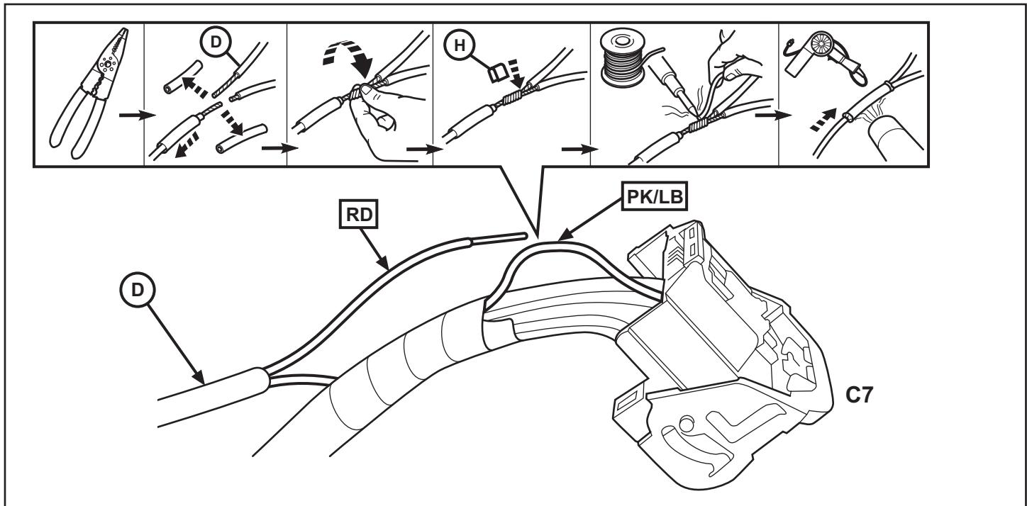
16. Dénudez l'extrémité des fils et localisez le fil blanc et jaune du connecteur C5 du faisceau de câbles. Joignez le fil bleu du nouveau faisceau de câbles (D) au fil blanc et jaune.
