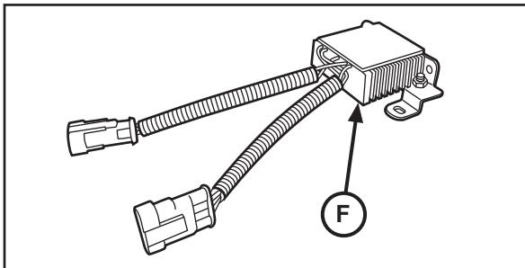
21. Enchufe los extremos del conector del arnés de corriente (D) y del arnés de la lámpara (C) al módulo de control. Encauce el arnés hacia abajo, entre la caja de Y y la parte interior de la pared de salpicadura y sujetelo sujetando cables según sea necesario.
