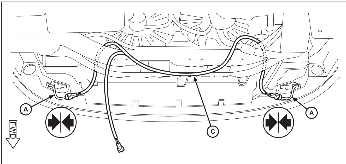
11. Sujete el arnés del faro con sujetacables junto al arnés existente, debajo de la fascia delantera, como se muestra. Encauce el cable flexible del arnés a través de la parte superior del compartimiento del motor.
