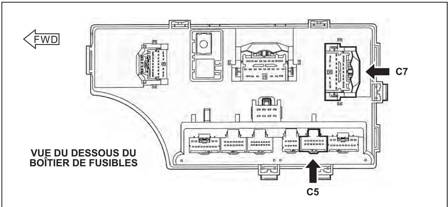
15. Dénudez l'extrémité des fils et localisez le fil rose et bleu pâle du connecteur C7 du faisceau de câbles. Joignez le fil rouge du nouveau faisceau de câbles (D) au fil rose et bleu pâle.
