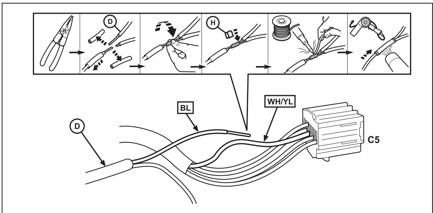
17. Isolez la jonction avec du ruban d'électricien et enrubaitez le faisceau de câbles. Reconnectez les connecteurs au boîtier de fusibles. Repoussez délicatement le boîtier de fusibles en position. Prenez garde de ne pincer aucun des fils des faisceaux de câbles.
