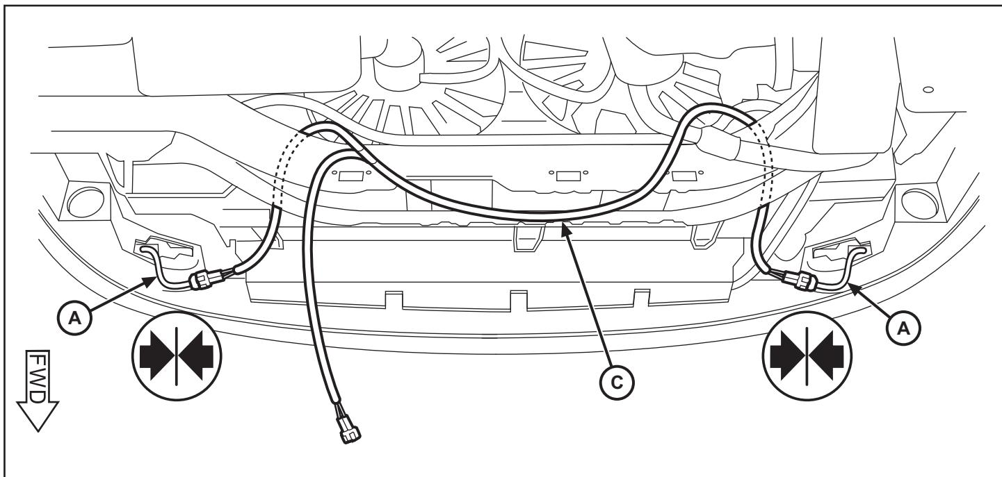
11. À l'aide d'attaches, fixez le faisceau de câbles des phares le long du faisceau de câbles existant derrière la façade du véhicule comme montré. Faites passer l'extrémité du faisceau de câbles vrillée à travers la paroi supérieure du compartiment moteur.
