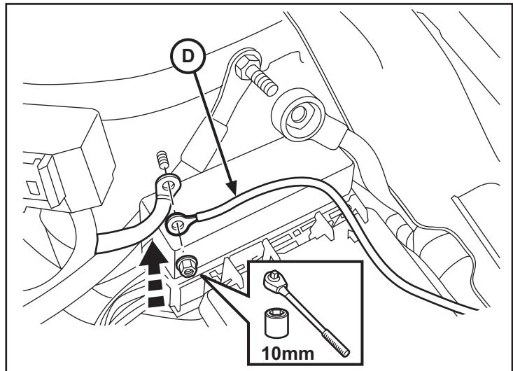
19. Localice y retire dos (2) tuercas de 10mm de la parte interior del borde de la salpicadera, junto a la caja de fusibles.
