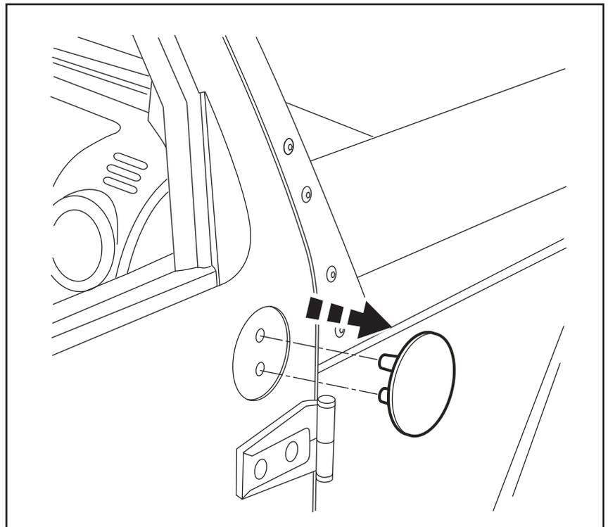
2. Insérez l'ensemble du miroir dans la portière en appuyant à la main seulement. Insérez deux (2) vis T-40 fournies à partir de l'intérieur de la porte. Serrer au couple de 9 Nm (6,5 lb-pi)
