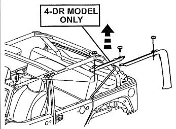
REMOVE THE SOFT TOP RAIL RETAINERS AS SHOWN (2-DR MODEL ONLY HAS 1 RETAINER PER SIDE)
