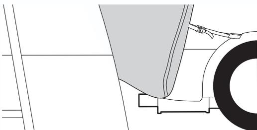
7) Attacher les courroies du toit au véhicule
