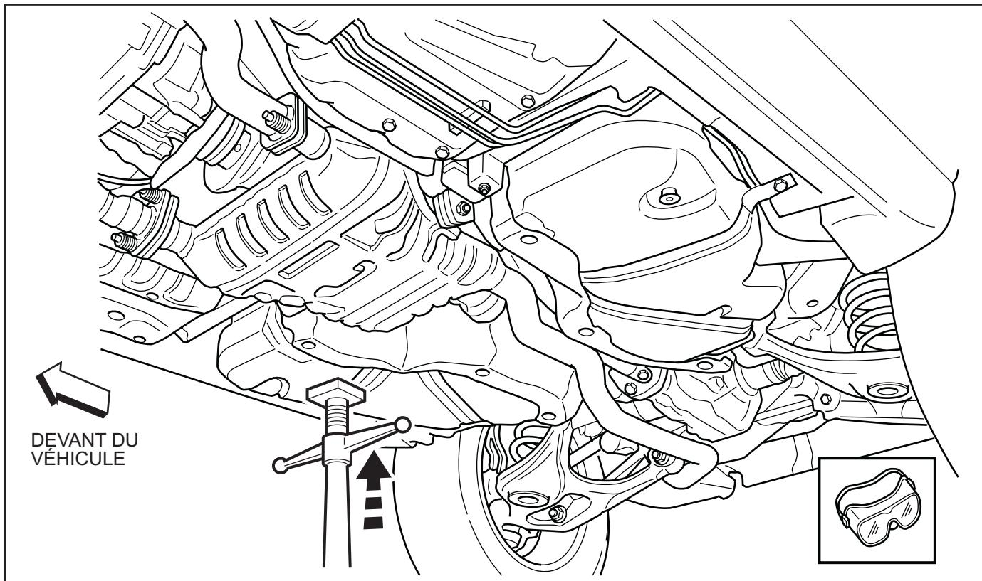
3. Retirez un (1) boulon de 13 mm et trois (3) boulons de 15 mm du pourtour du réservoir de carburant.
