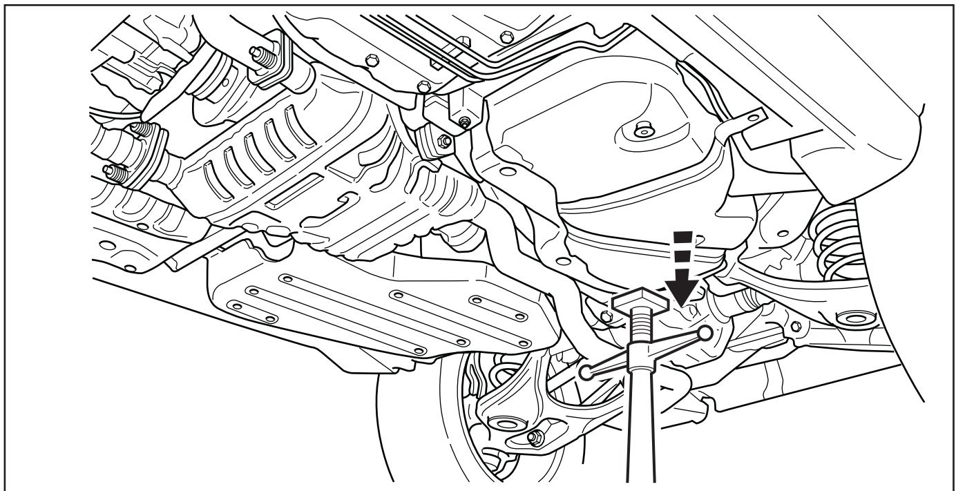
9. Installez la partie gauche de la plaque de protection du réservoir en boulonnant un (1) boulon de fixation de 13 mm et trois (3) boulons de fixation de 15 mm sur le pourtour du réservoir.
