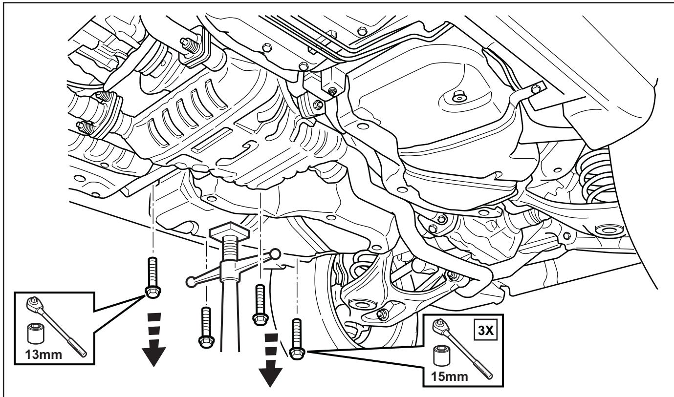
4. Descendez délicatement la béquille installée sous le réservoir. Le réservoir s'affaissera quelque peu mais demeurer suspendu au véhicule.
