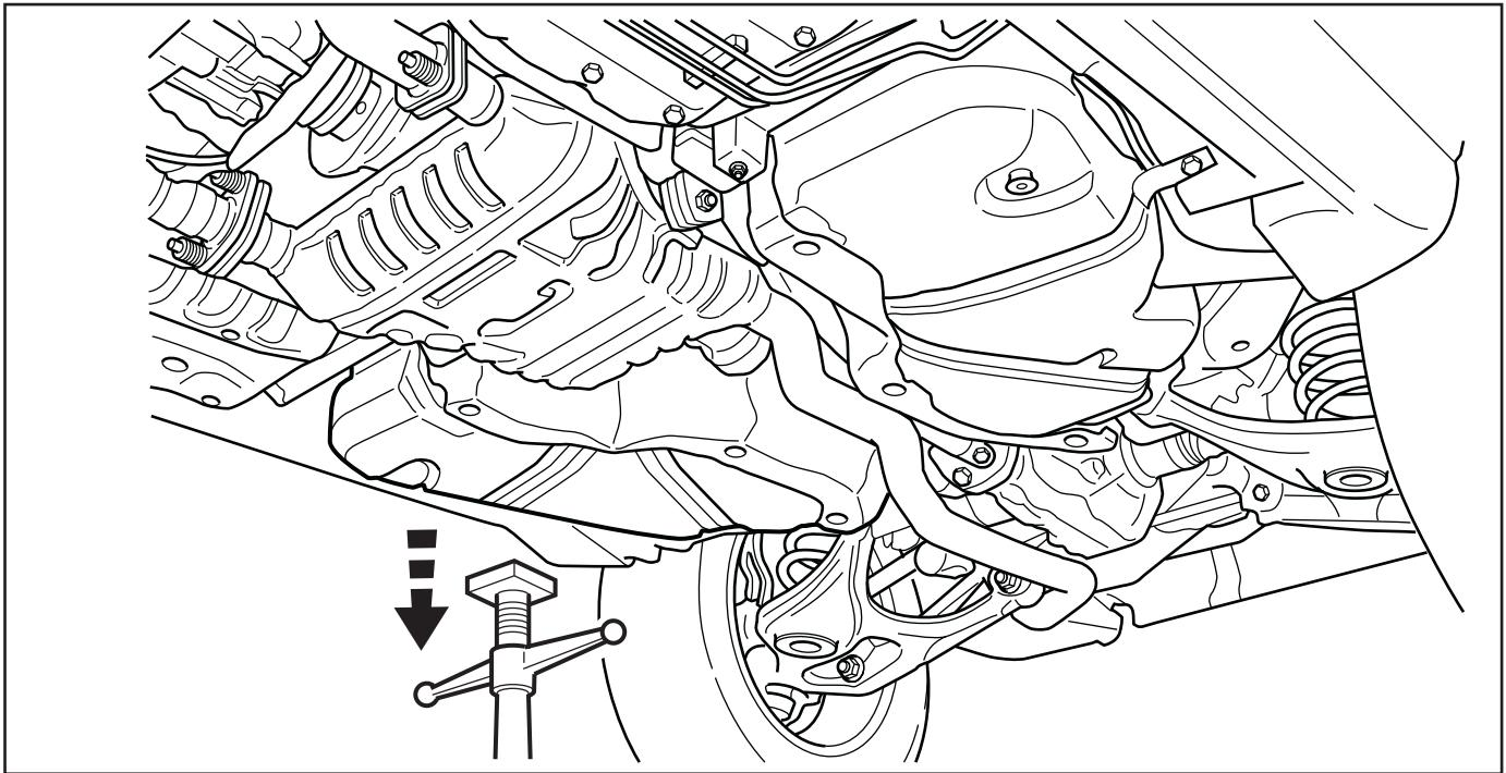
5. Installez la partie droite de la plaque de protection du réservoir en boulonnant un (1) boulon de fixation de 13 mm et trois (3) boulons de fixation de 15 mm sur le pourtour du réservoir.
