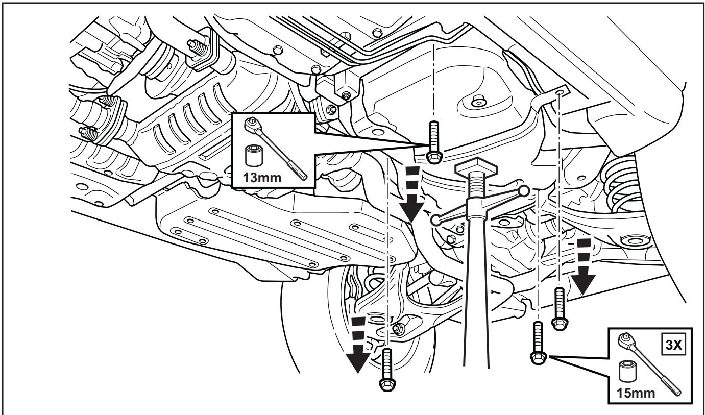
8. Descendez délicatement la béquille installée sous le réservoir. Le réservoir s'affaissera quelque peu mais demeurera suspendu au véhicule.
