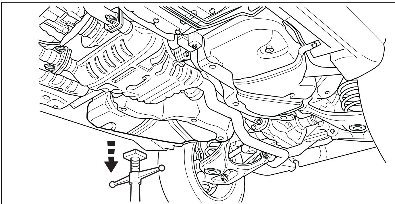
5. Instale la placa protectora derecha al tanque de combustible con los pernos de apoyo, uno (1) de 13mm y tres (3) de 15mm en ubicaciones alrededor del tanque.
