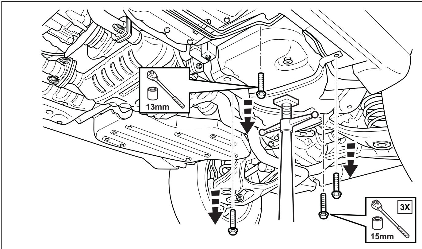
8. Descienda con cuidado la torreta de seguridad para colocarla debajo del tanque de combustible. El tanque se combará ligeramente, pero se mantendrá apoyado con el vehículo.
