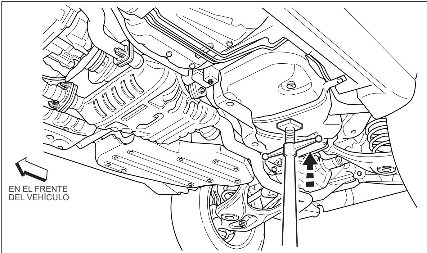
7. Retire los pernos de apoyo, uno (1) de 13mm y tres (3) de 15mm alrededor del tanque de combustible.
