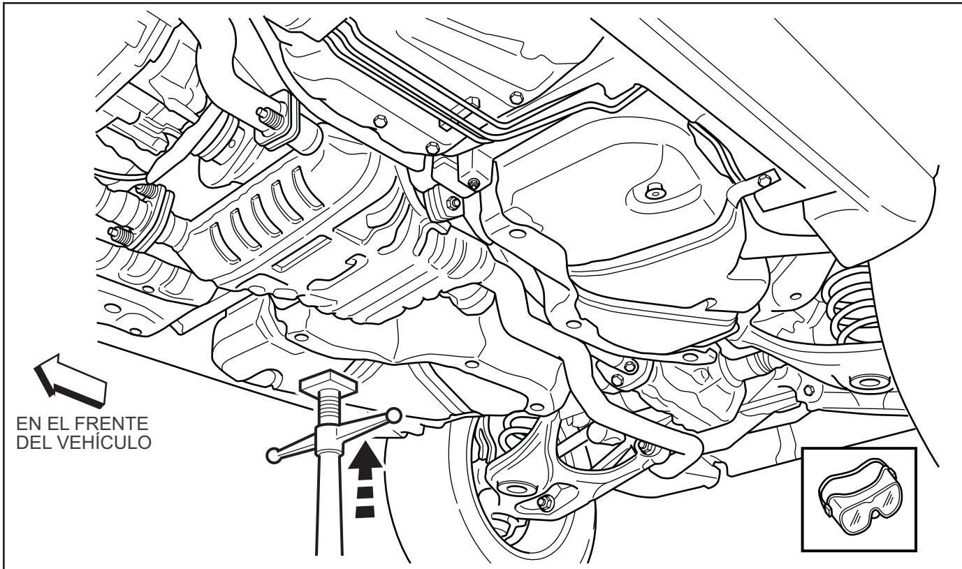
3. Retire un (1) perno de 13mm y tres (3) pernos de apoyo de 15mm de ubicaciones alrededor del tanque de combustible.
