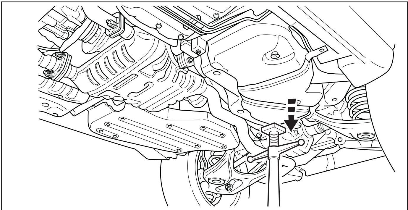
9. Instale la placa protectora izquierda al tanque de combustible con los pernos de apoyo, uno (1) de 13mm y tres (3) de 15mm en ubicaciones alrededor del tanque.
