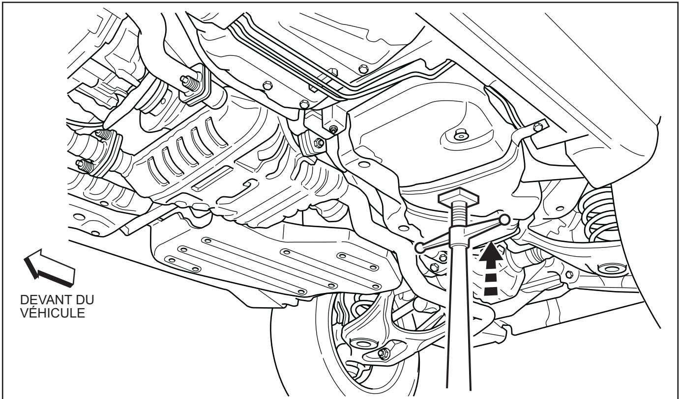
7. Retirez un (1) boulon de 13 mm et trois (3) boulons de 15 mm du pourtour du réservoir de carburant.
