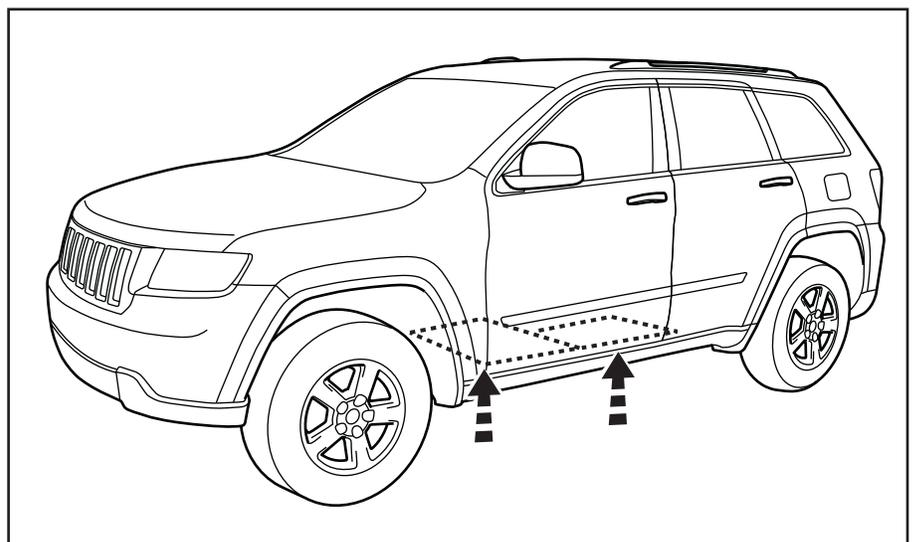
3. Retirez les deux traverses métalliques du dessous du véhicule, comme indiqué. Retirez le panneau couvercle en plastique de la côté conducteur du véhicule.
