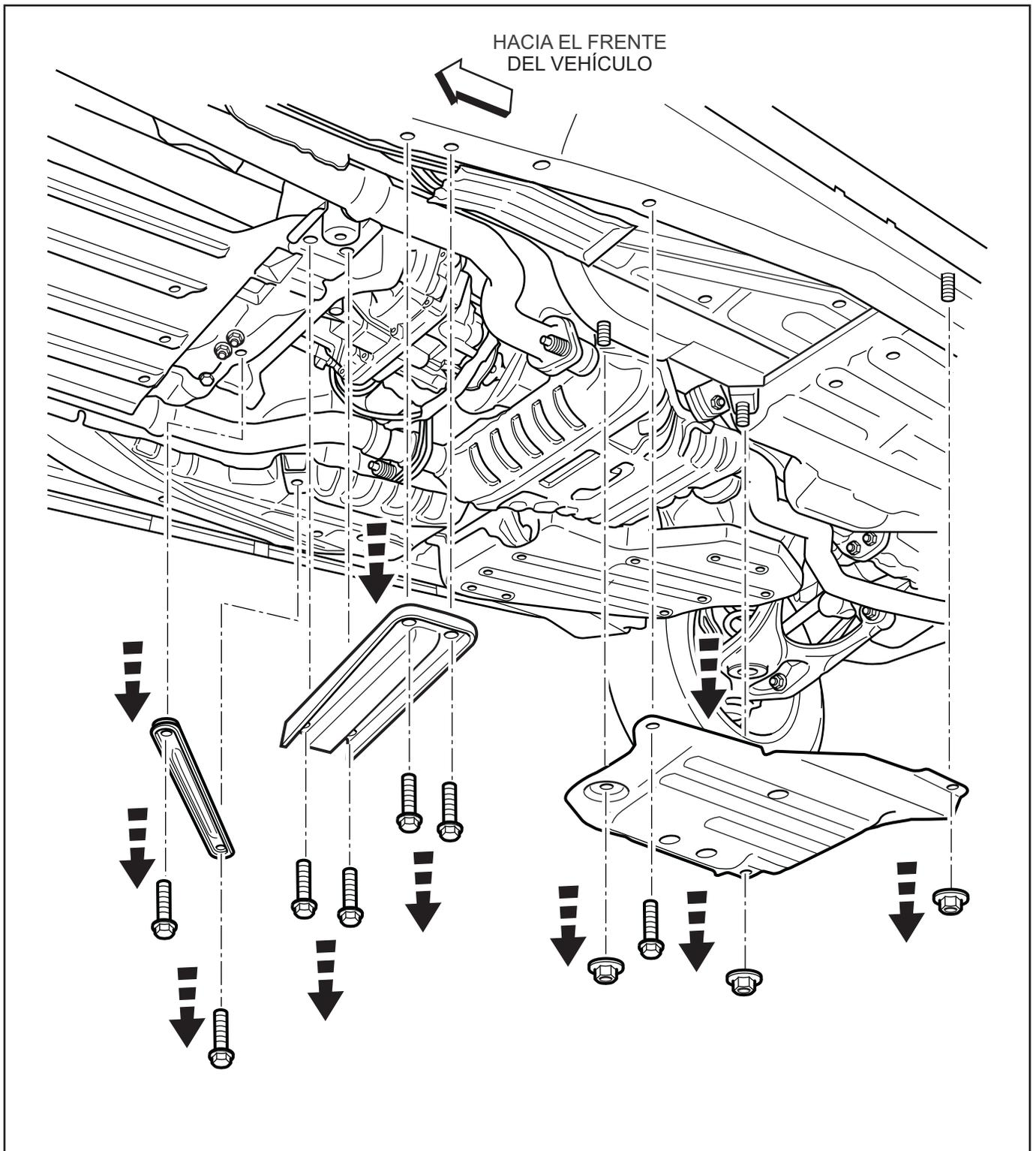
4. Sujete la placa protectora de la combustible paquete (B) en su lugar como se ilustra, utilizando los tres (3) tuercas de 16mm que vienen incluidos. Apriete los tornillos a 20 Nm (15 lb in).
