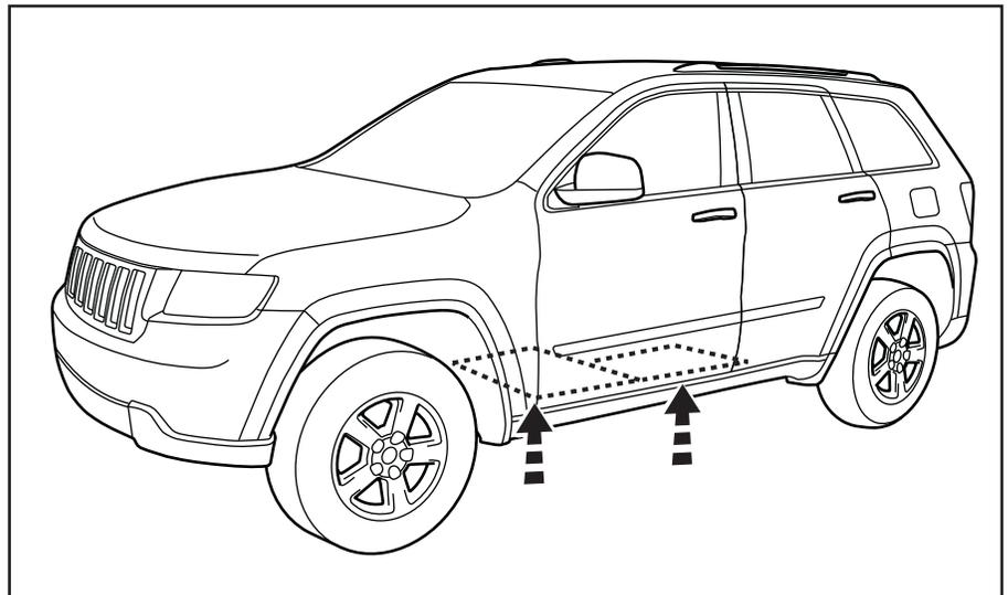
3. Retire los dos crucetas de metal de la parte inferior del vehículo, como se muestra. Quitar la cubierta de plástico de la del lado del conductor del vehículo.
