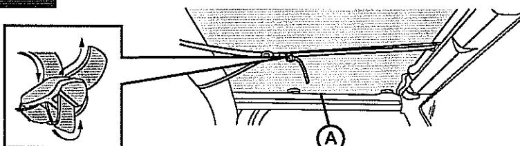
**Enlace la correa a través de la abrazadera que está sobre el parabrisas. Jale el extremo de la correa hacia atrás y hágalo pasar por la hebilla. Jale y tense firmemente.**
