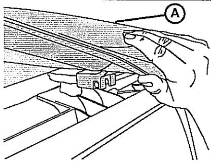
**Coloque el Techo Plegable sobre el vehículo. Enganche el adaptador del cuerpo del vehículo a cada lado sobre el reborde que circunda a la puerta.**
