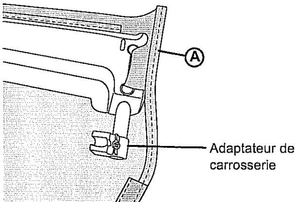
Dirija el Techo Plegable con el adaptador del cuerpo del vehículo, orientado hacia el frente.
