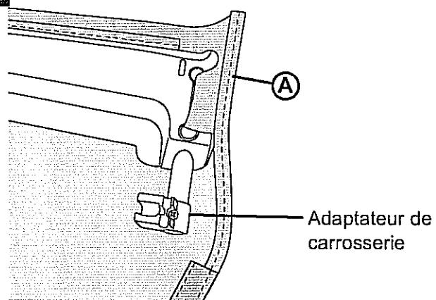
Orienter le capot pare-soleil avec l'adaptateur de carrosserie en direction de l'avant.
