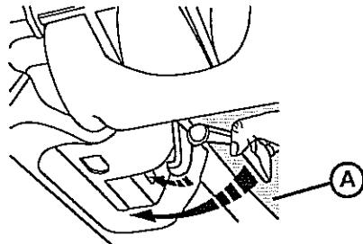
Attacher l'avant du capot pare-soleil au pare-brise.
